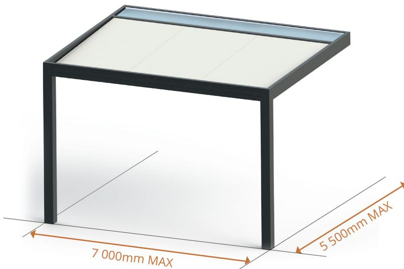
Au delà de 6 000mm, un 3ème poteau est nécessaire à la jonction de la poutre transversale. Obligatoire en zone C.
