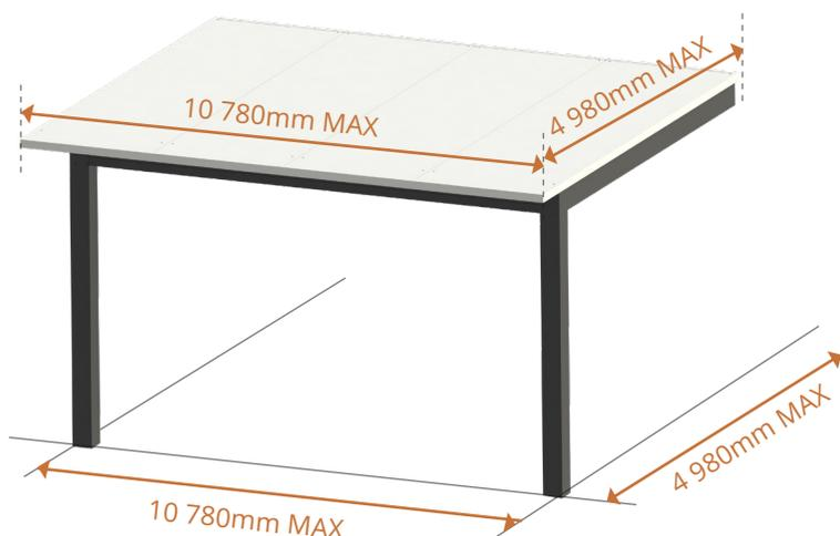
Au delà de 4 780mm, un 3ème poteau est nécessaire à la jonction de la poutre transversale.
