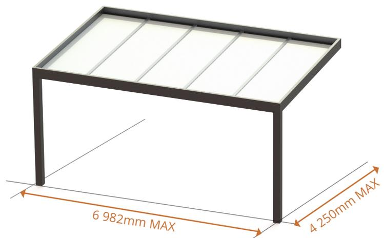
Au delà de 4 506mm, un 3ème poteau est nécessaire à la jonction de la poutre transversale.
